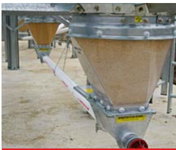
ABERTURA DE TOLVA DE 16 PULGADAS
